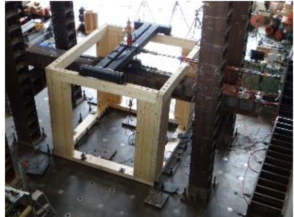
耐震実験の様子(大地震時にも安全な設計基準を定め実験にて検証)
